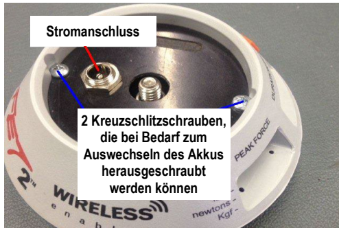
Abbildung 9. Aufladen des Geräts und Zugang zum Akku
