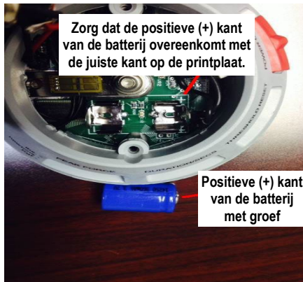
Afbeelding 10. Vervangen van de batterij
