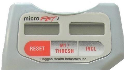
**Abbildung 2.** microFET<sup>®</sup>3-Tasten und LCD-Displays
