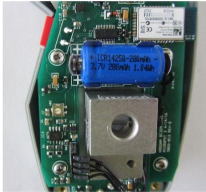
**Abbildung 14. Einsetzen des Akkus**
