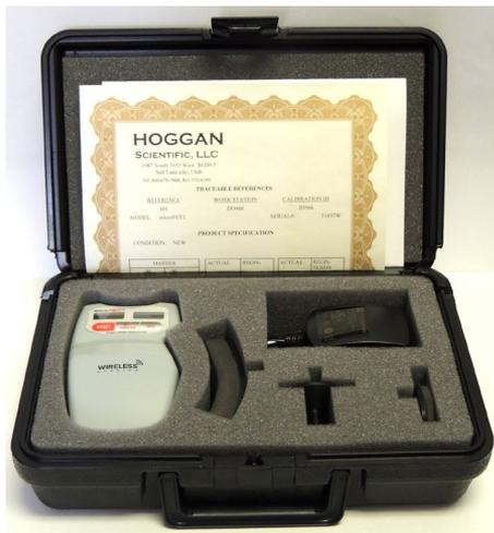
**Abbildung 1.** Das microFET®3-Gerät im mitgelieferten Tragekoffer
