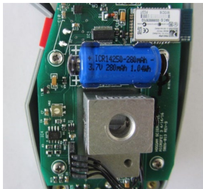
Figura 14. Cambio de la batería
