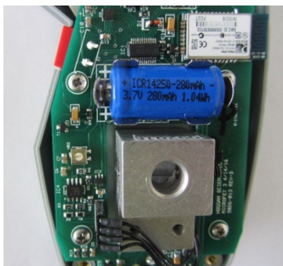
Figure 14 : Remplacement de la batterie
