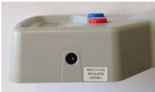
Abbildung 8. Stromanschluss für das Laden des Geräts
