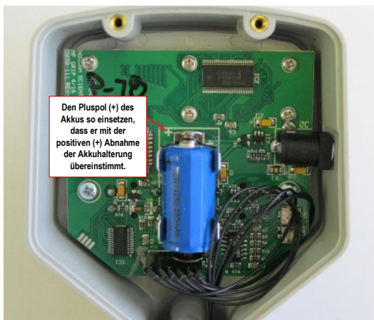
Abbildung 9. Einsetzen des Akkus
