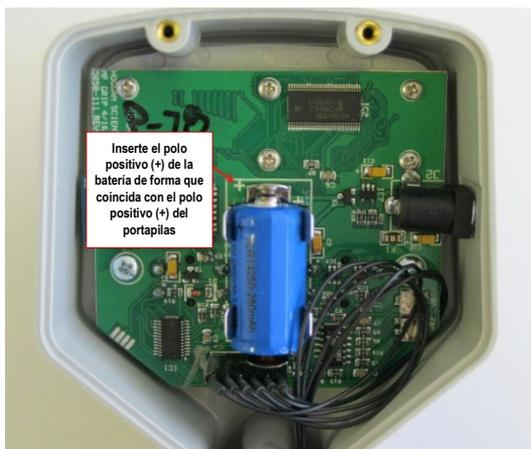
**Figura 9. Cambio de la batería**
