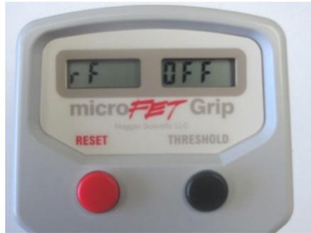
**Figura 4.** Ajuste del modo inalámbrico
