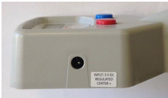
**Figure 8 :** Connecteur d'alimentation pour le chargement du dispositif
