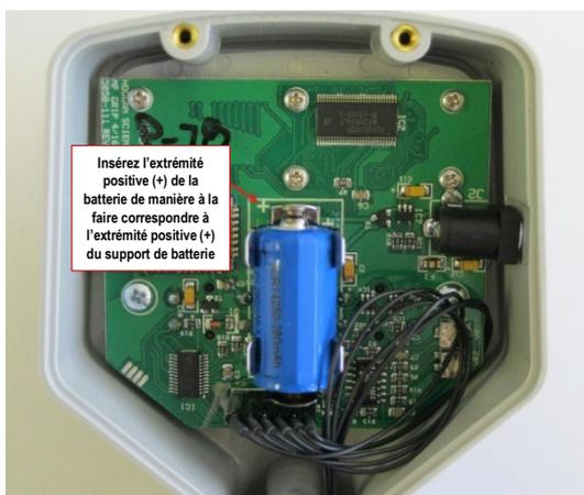
**Figure 9 : Remplacement de la batterie**
