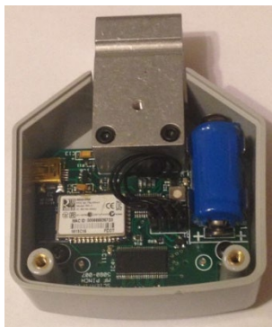
Figure 10 : Remplacement de la batterie
