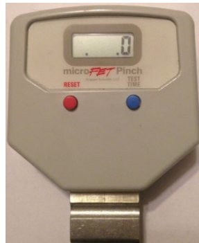
Afbeelding 6. Punt ter indicatie van de draadloze modus
