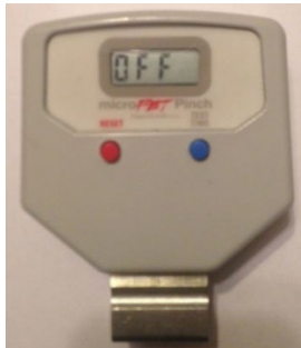
Afbeelding 4. Instelling OFF (UIT) voor draadloze modus
