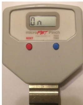
Afbeelding 5. Instelling ON (AAN) voor draadloze modus
