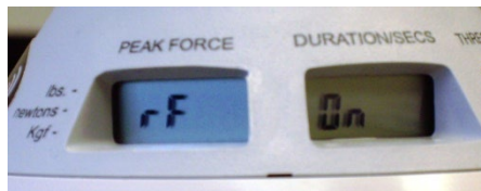
Figur 4. Indstilling af trådløs tilstand
