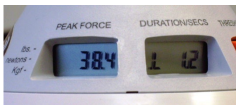
Figur 5. LCD-skærme/Tærskelindstilling og testresultat
