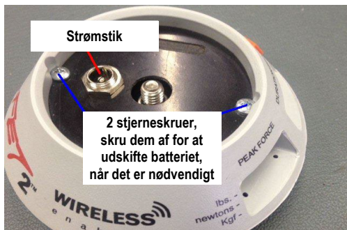
Figur 9. Opladning af enhed og adgang til batteriet
