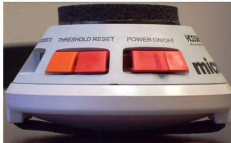
**Abbildung 2. Gerätetasten**
