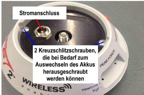
**Abbildung 9.** Aufladen des Geräts und Zugang zum Akku
