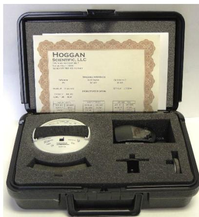
**Figura 1.** Dispositivo microFET<sup>®</sup>2 en el estuche de transporte suministrado
