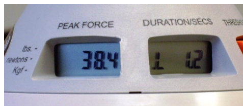
Figure 5 : Fenêtres d'affichage LCD/Configuration des seuils et résultats des tests d'échantillonnage
