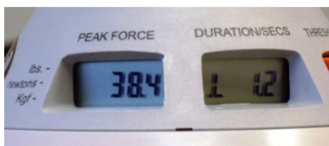
Bild 5. LCD-displayer/Inställt tröskelvärde och exempel på testresultat
