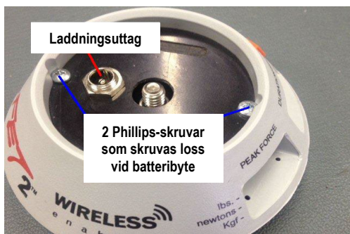
Bild 9. Laddning av apparaten och batteriåtkomst
