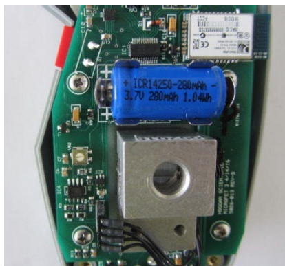
Figur 14. Udskiftning af batteri
