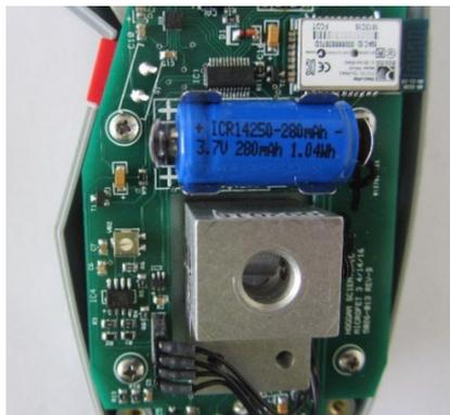
**Abbildung 14. Einsetzen des Akkus**
