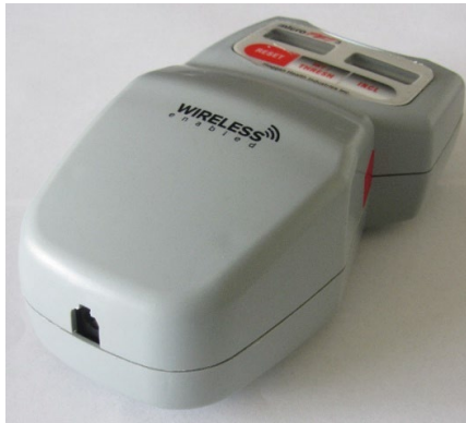
Figure 13 : Connecteur d'alimentation pour le chargement du dispositif
