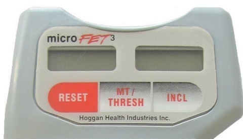
Figure 2 : Boutons d'affichage et écrans LCD du microFET ®3
