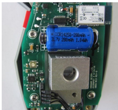
Figure 14 : Remplacement de la batterie
