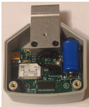
Figura 10. Cambio de la batería
