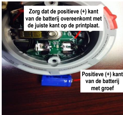
Afbeelding 10. Vervangen van de batterij
