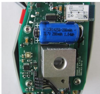
Figur 14. Udskiftning af batteri
