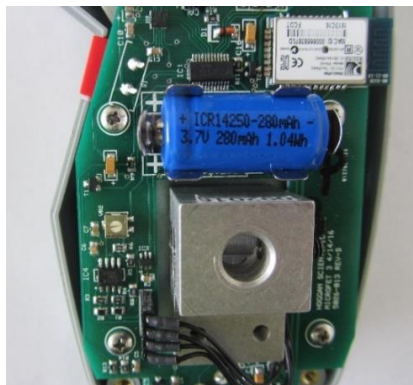
Abbildung 14. Einsetzen des Akkus
