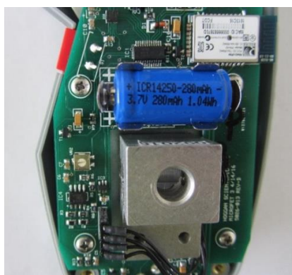
Figure 14 : Remplacement de la batterie
