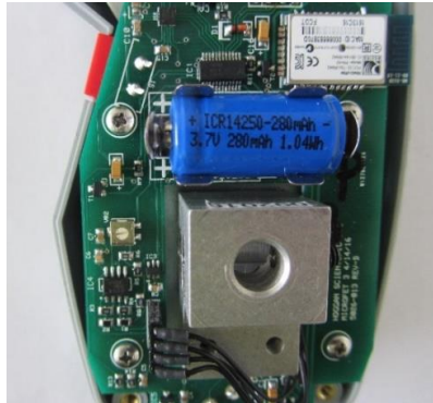
Bild 14. Byte av batteri
