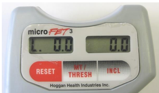
Bild 10. Indikator för inställt tröskelvärde/trådlöst läge på
