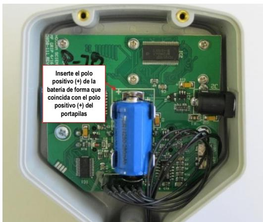
**Figura 9. Cambio de la batería**
