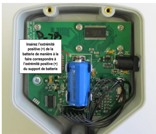
Figure 9 : Remplacement de la batterie
