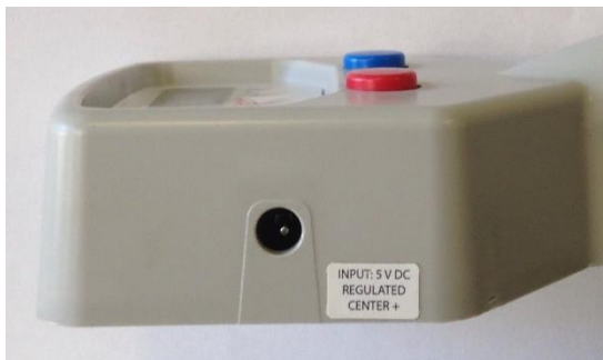
Figure 8 : Connecteur d'alimentation pour le chargement du dispositif
