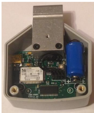
Figure 10 : Remplacement de la batterie
