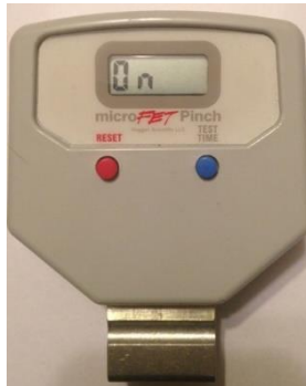
Figure 5 : Configuration du mode sans fil ON (Activé)
