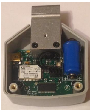
Afbeelding 10. Vervangen van de batterij
