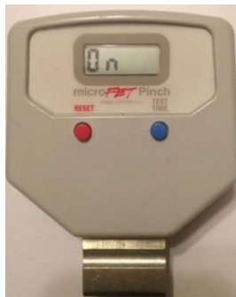
Afbeelding 5. Instelling ON (AAN) voor draadloze modus
