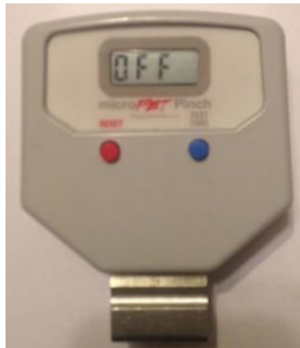
Afbeelding 4. Instelling OFF (UIT) voor draadloze modus
